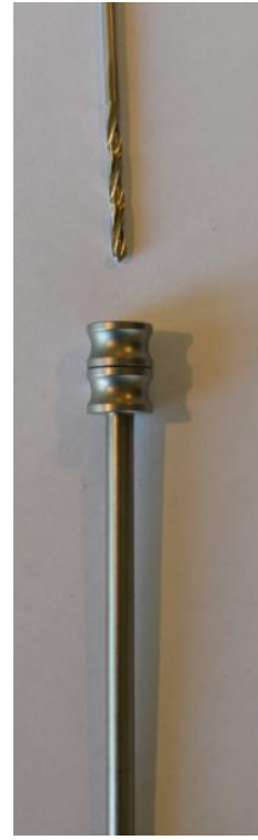
Figuur 24 Plaats de 3.5.mm boor
