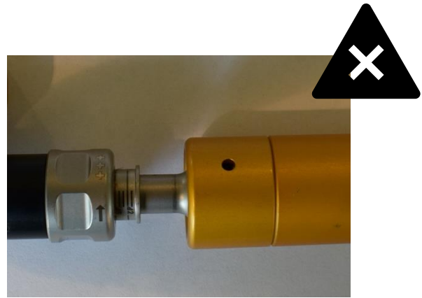
Figuur 11 Onjuiste positie van het metalen duimwiel
