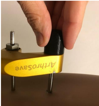
Figuur 56 Plaatsen van de plastic botpenbeschermdoppen over de geknipte botpen.
