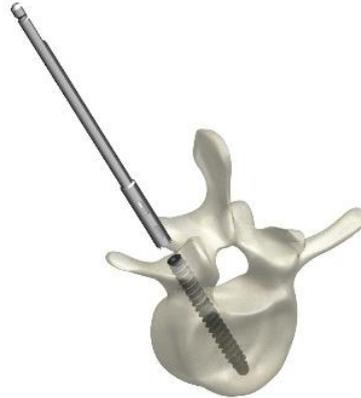
O trépano é perfurado no sentido contrário aos ponteiros do relógio, diretamente sobre o eixo do parafuso. Para a perfuração, utilizar uma ferramenta elétrica padrão com uma conexão AO.
